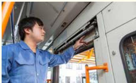
▲自動扉の上には扉を動かすための機器が入っているんだ。自動扉は空気の方で動いているので、空気漏れがないかどうか確認しているよ。
