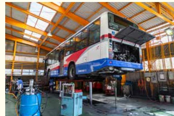
▲タイヤなどの「足回り」を点検するときには、大きなバスの車体をリフトで持ち上げて作業するんだ。ちなみに写真のバスの重さは約13t！
