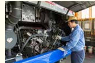
◀バスの後部にあるエンジン回りの点検。オイル漏れ・水漏れはないか、ベルト類に亀裂はないかなどを確認しているよ。
